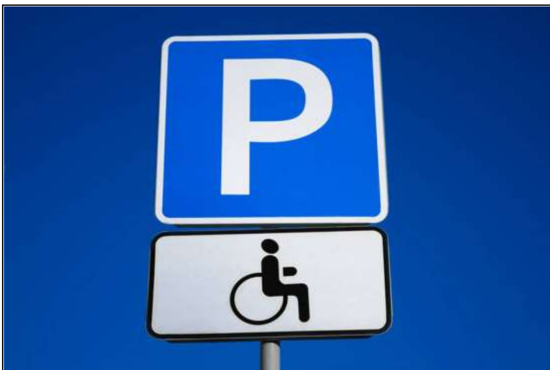
Рисунок 40 – Примеры обозначения машино-места для стоянки (парковки) транспортного средства инвалида с использованием дорожных знаков.
